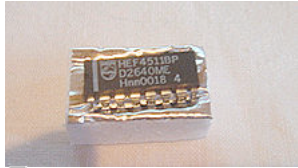
A CMOS 4000 IC in a DIP
